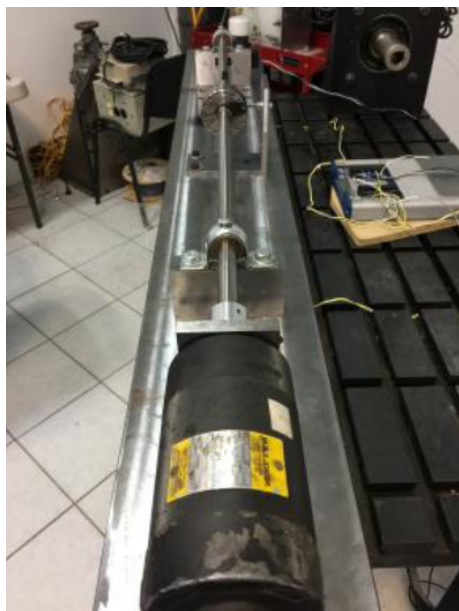
Figura 1. Banco de pruebas experimentales de rotor Jeffcott
