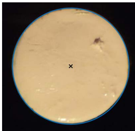
Figura 8: Imagen del tubo sin escarcha y geometría de referencia calculada
