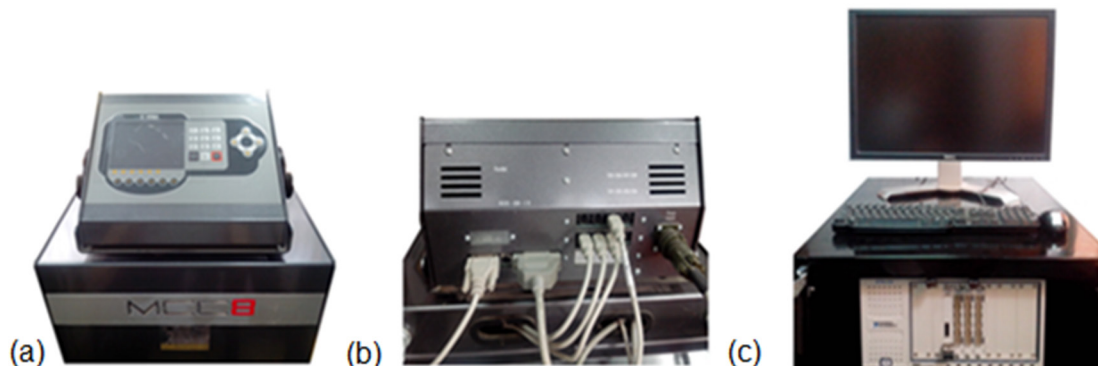
Figura 3. Consola de comando de la máquina de ensayos: (a) parte frontal, (b) parte posterior, (c) SAD.
