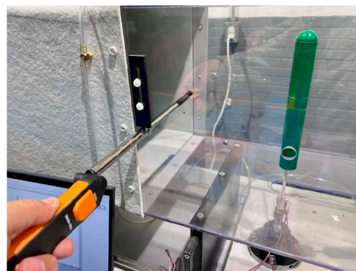
Figura 6. Anemómetro de hilo caliente para la medición de la velocidad de viento de prueba.
