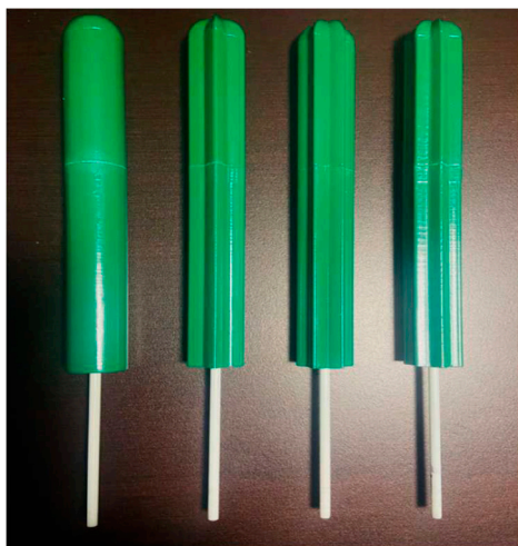
Figura 4. Mástiles fabricados con impresión 3D.
