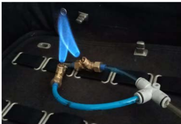
Figura 21 – Flama con alto contenido de metano
