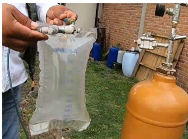
Figura 9 – Biogás contenido en bolsa tipo venoclisis
