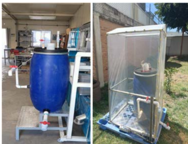
Figura 17 – Construcción de biodigester de 150 litros
