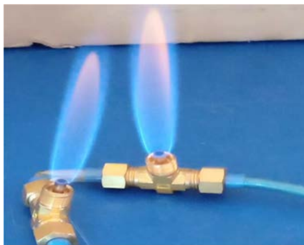
Figura 10 – Prueba de flama en biogás
