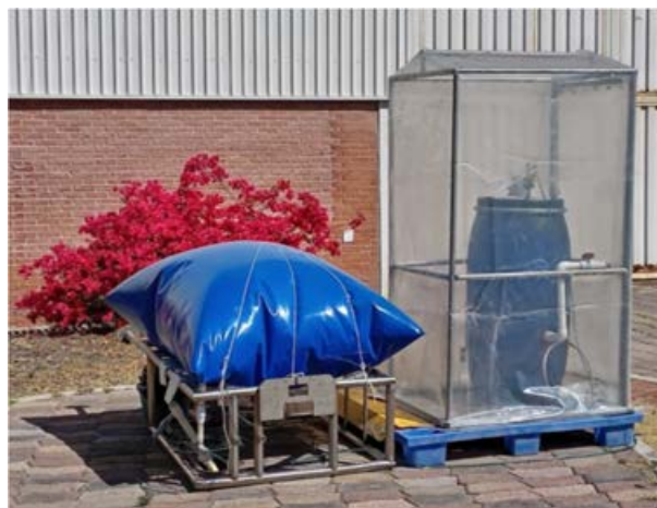
Figura 18 – Operación de biodigester de 150 litros
