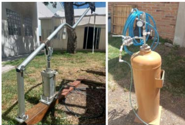
Figura 13 – Sistema de compresión manual de biogás
