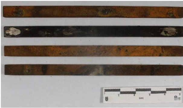
Figura 7. Inspección macroscópica del acero A1DM.
