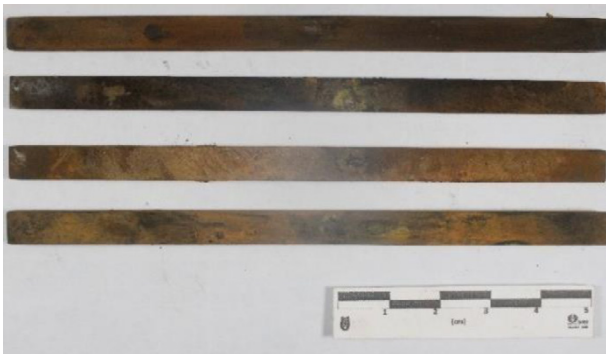
Figura 8. Inspección macroscópica del acero A2DM.
