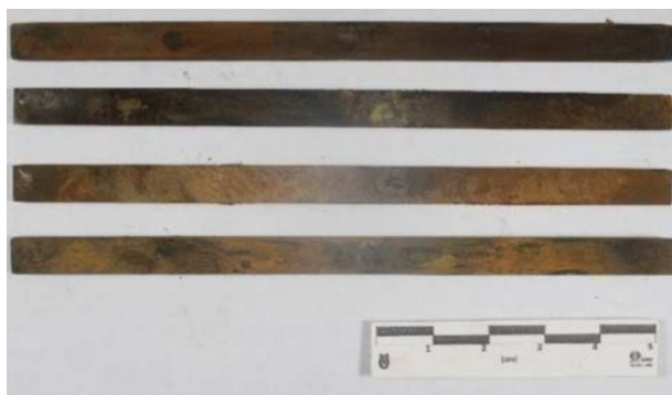
Figura 8. Inspección macroscópica del acero A2DM
