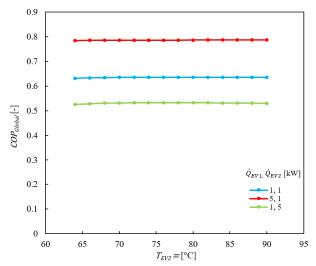
**Figura 6**. Comparación del  $COP_{Global}$  a diferentes calores de los  $\dot{Q}_{EVI}$  y  $\dot{Q}_{EV2}$  a diferentes temperaturas del  $T_{EV2}$ .
