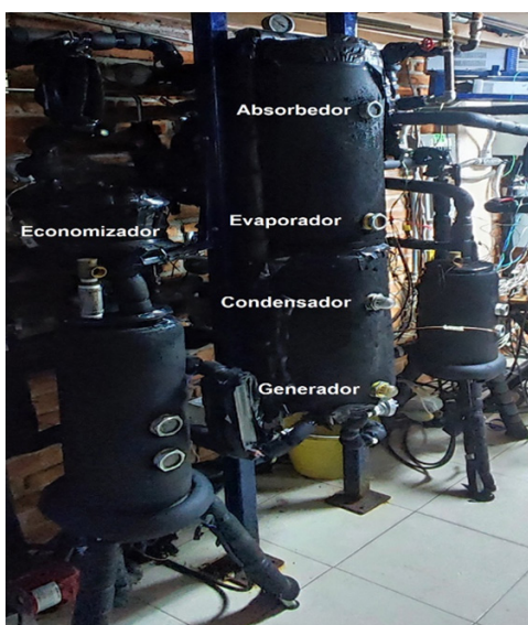
Figura 2b. Bomba de calor por absorción (Tipo II) experimental para calentamiento.
