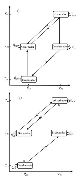
Figura 1. Ciclos termodinámicos de la BCA, a) Tipo I, b) Tipo II.
