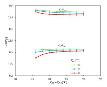
Figura 4. Análisis de operación del  $COP_{Col}$  y  $COP_{Eof}$  a diferentes  $T_{CO}$ .
