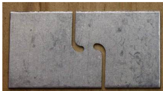
Figura 5 – Probeta maquinada mediante CNC.
