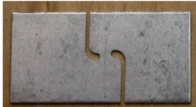
**Figura 5**– Probeta maquinada mediante CNC.
