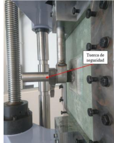
Figura 35. Colocación de tuerca de seguridad.
