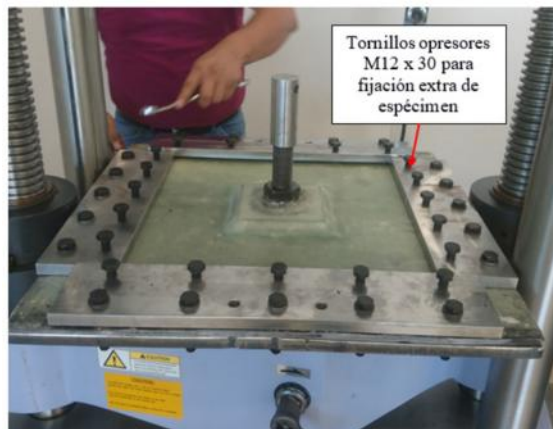
Figura 30. Posicionamiento de tornillos opresores de espécimen en las placas de presión.
