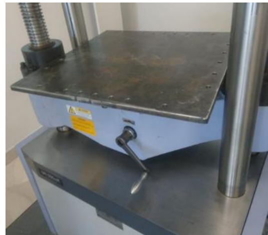
Figura 27. Posicionamiento de placa base sobre máquina de ensayos.
