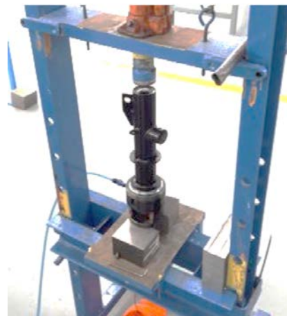
Figura 5 – Prueba experimental de prototipo para validación de funcionamiento de sellos
