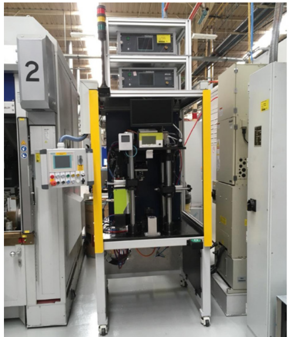
Figura 17 – Estación de prueba de fuga doble
