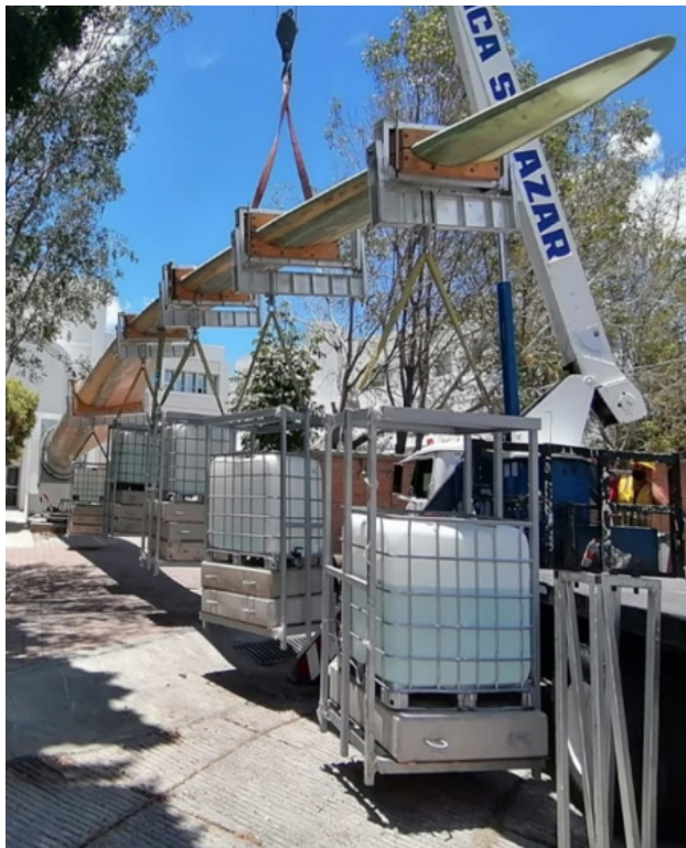
Figura 27 – Prueba estática del aspa
