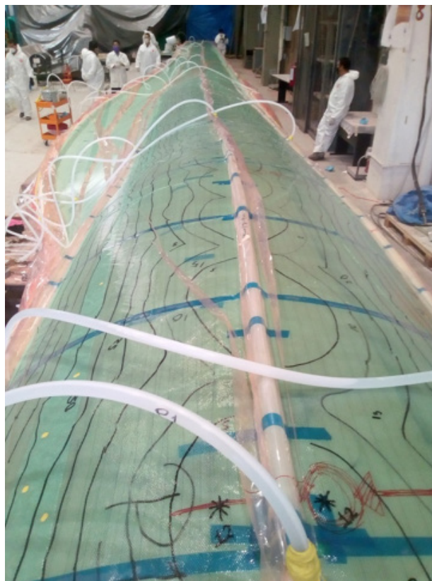
Figura 14 – Impregnación de fibras mediante el proceso de infusión.
