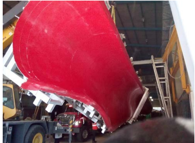
Figura 18 – Volteo del molde LP mediante grúas
