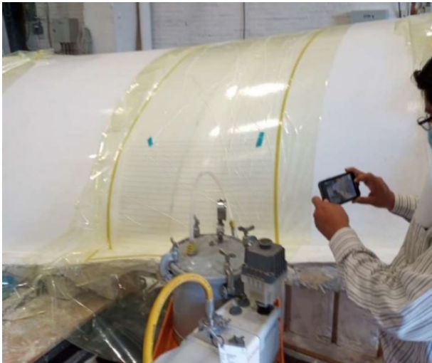
Figura 9 – Prueba de estanqueidad
