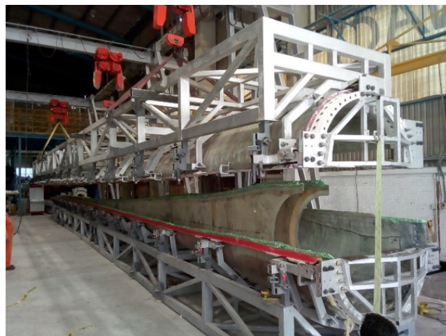
Figura 26 – Uso de adhesivo estructural epóxico
