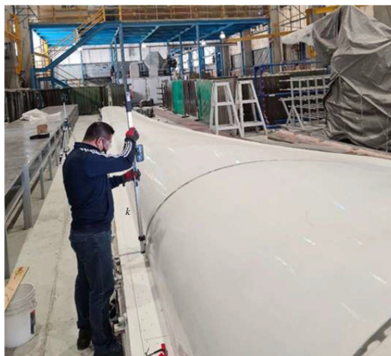
Figura 7 – Verificación de lecturas mediante láser
