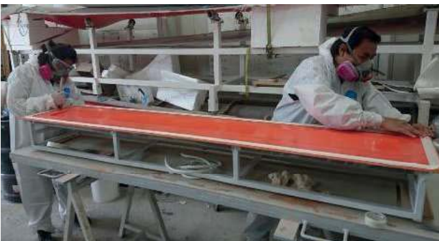
Figura 19. Fabricación del molde para las aspas Darrieus
