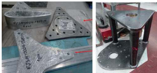
Figura 24. Soportería para los rotores Savonius y Darrieus
