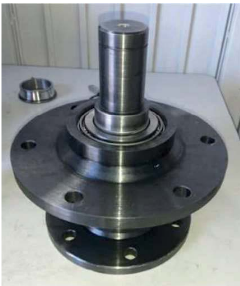
Figura 27. Ensamble del tren de potencia
