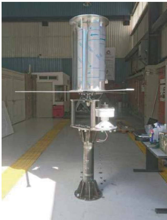
Figura 28. Ensamble preliminar de rotor Savonius sobre estructura principal
