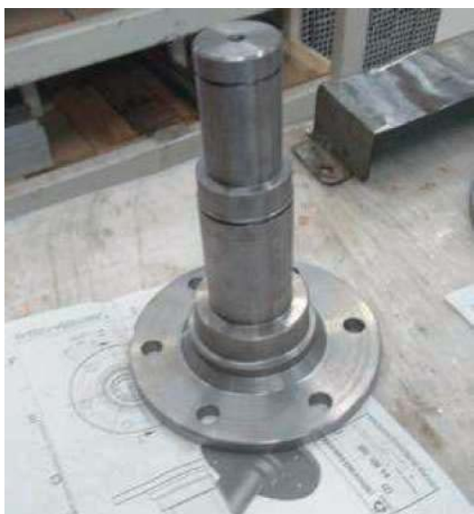
Figura 23. Flecha principal del tren de potencia
