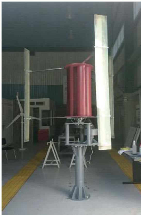
Figura 29. Ensamble final de la turbina de eje vertical
