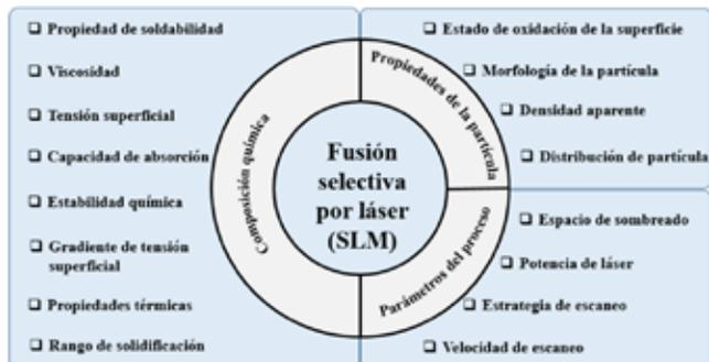
Figura 1. Diagrama de los parámetros que intervienen en el proceso de SLM
