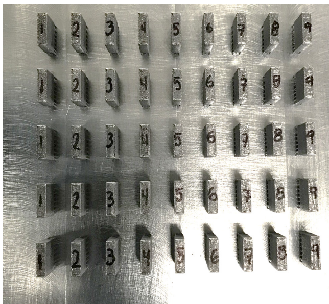
Figura 3. Orientación de las probetas en la cámara de impresión.
