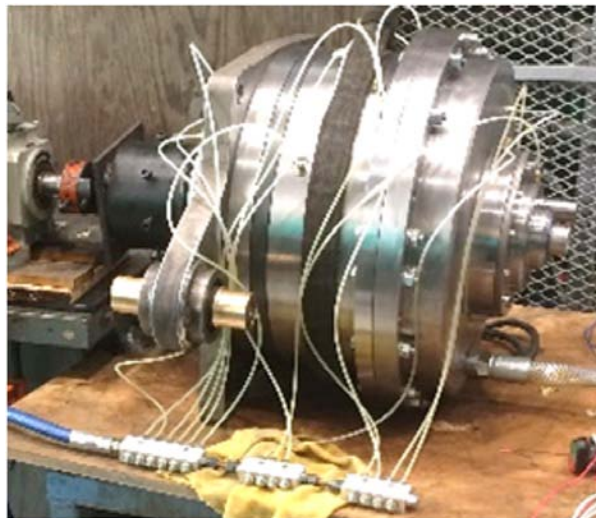
Figura 15. Pruebas del sistema de lubricación.
