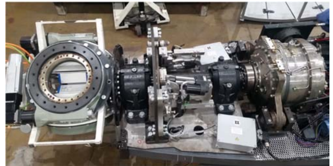
Figura 21. Montaje de la caja de engranes sobre el chasis (cubo-sistema de frenado-caja multiplicadora).
