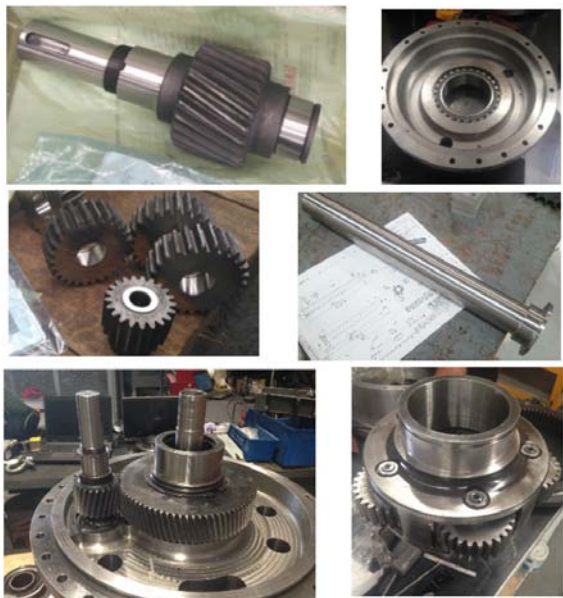
Figura 12. Componentes principales y sub-ensambles de la caja de engranes.
