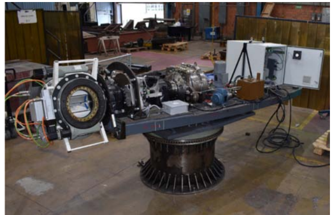
Figura 22. Chasis ensamblado del aerogenerador para pruebas en laboratorio.
