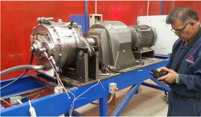
Figura 17. pruebas en vacío de la caja multiplicadora en un banco diseñado para propósito específico.
