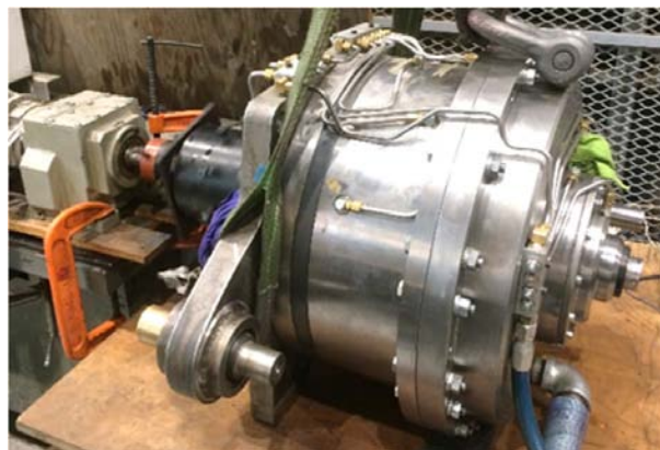
Figura 16. Prototipo de caja de engranes con el sistema de lubricación con la tubería de uso rudo.
