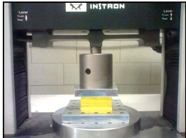
Figura 3.1. Prueba de compresión a materiales hiperelásticos.
