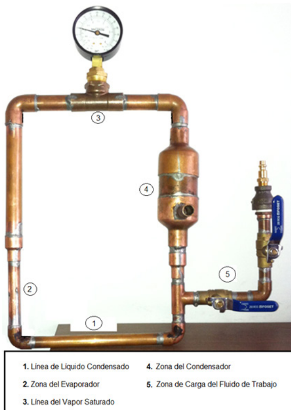
Figura 3. Termosifón de contorno usado en las pruebas (Sánchez Martínez [20]).
