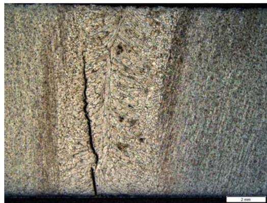
Figura 8. Agrietamiento de la unión soldada.
