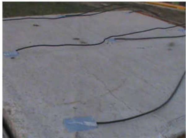
Figure 2 - Prototipo de vivienda con techo de concreto de 1m x 1m x 1m utilizado para realizar mediciones de temperatura.
