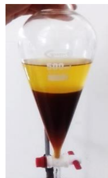
Figura 2 – Separación del biodiesel y la glicerina.
