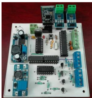
Figura 16: Tarjeta de adquisición de datos y de control, instrumentada para la silla de ruedas motorizada.
