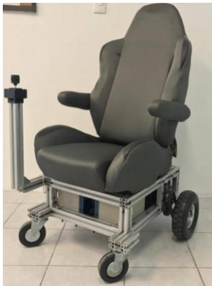
Figura 15: Prototipo final de la silla de ruedas motorizada
