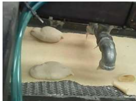
Figura 22. Exceso de relleno.
