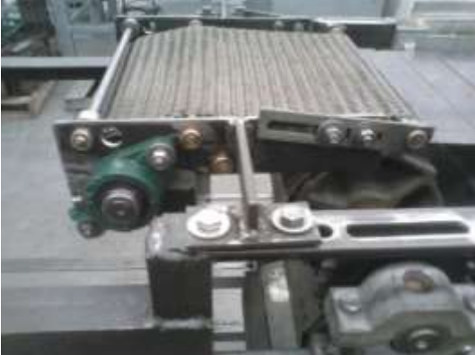
Figura 6. Extensión de banda transportadora de malla.
