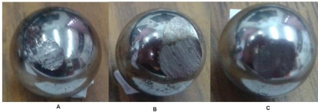
Figura 6 – Rompimiento de Película Lubricante: (A) aceite nuevo; (B) aceite cojinete de carga y (C) aceite cojinete guía.
