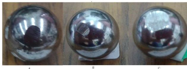
Figura 5 – Desgaste obtenido con (A) aceite nuevo; (B) aceite cojinete de carga y (C) aceite cojinete guía.
