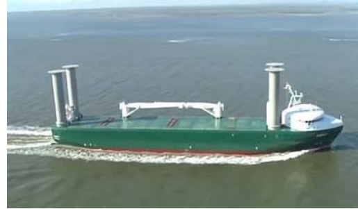
Figura 5- Embarcación que logra el empuje con los cuatro cilindros verticales sobre su cubierta.
