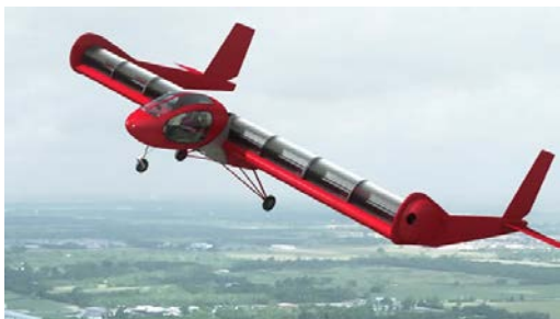
Figura 4- Aeromodelo que logra la sustentación con el cilindro giratorio que sustituye al ala.
